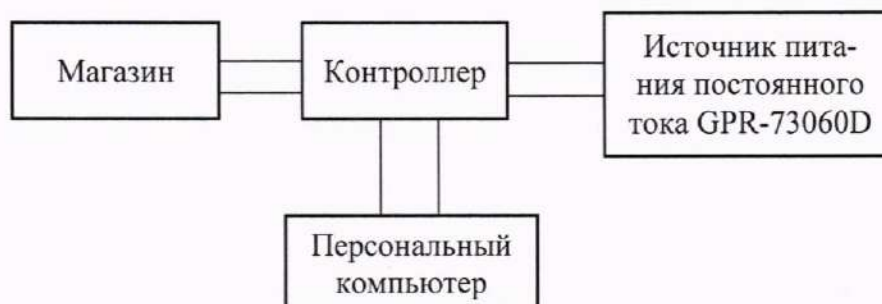
Рисунок 3 – Схема подключения
