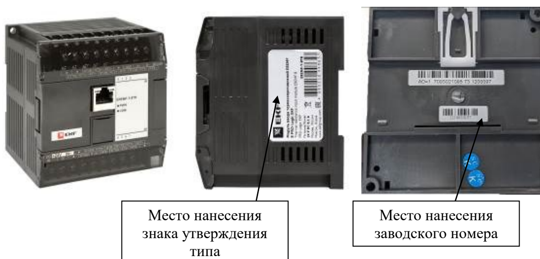
Рисунок 6 – Общий вид модулей расширения EREMF с указанием места нанесения знака утверждения типа и заводского номера
