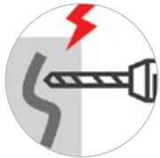
Механическое повреждение изоляции
